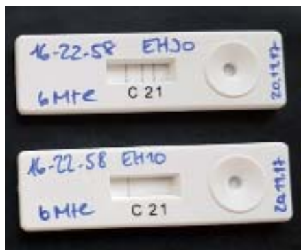
Photo 2: bandelettes de test avec résultat positif: les deux bactéries marqueuses ont pu être détectées (bandelette du haut). Bandelettes de test avec un résultat négatif: seule la bandelette de contrôle est visible. Aucune bactérie marqueuse n'a été détectée (bandelette du bas).
